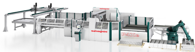
Automatické nakladanie zo stola a robotické vykladanie na paletu
